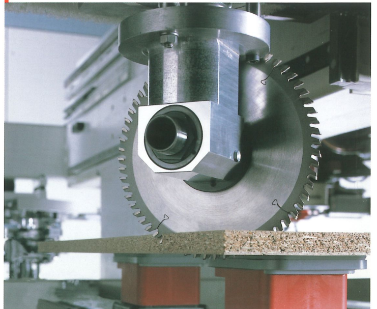
Hauptspindel mit C-Achse und Adapteraggregat »Sägen«
