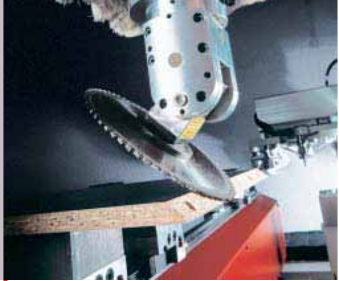
Hauptspindel mit schwenkbarem Sägeaggregat
