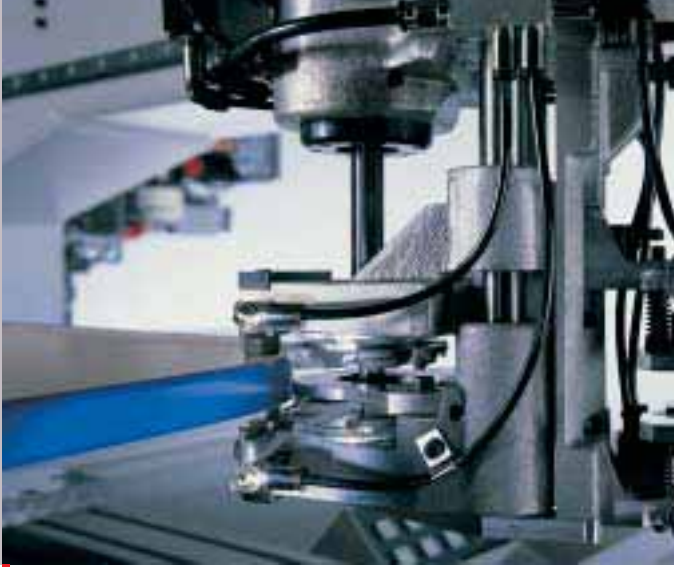
Kombiaggregat: Bündigfräser und Flachziehklinge
