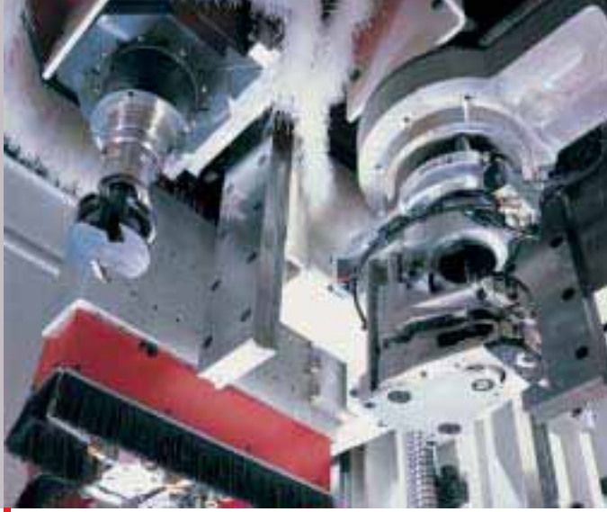
Hauptspindel und Nebenspindel mit Bohraggregat
