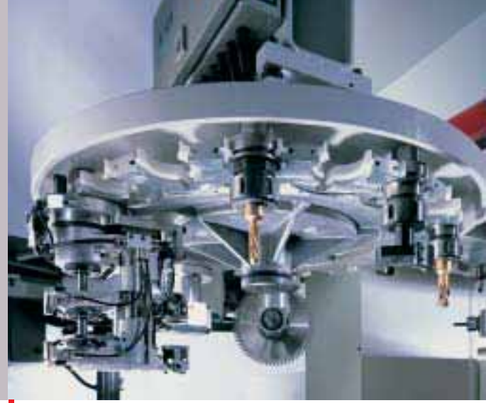
18-fach Werkzeugwechsler für den Einsatz von Adapteraggregaten
