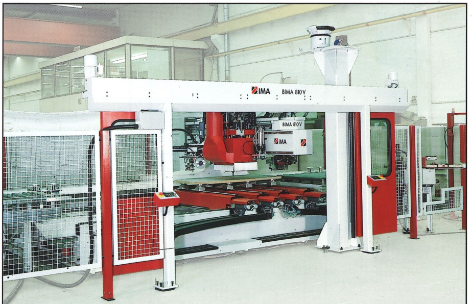
BIMA 810 V im Durchlaufbetrieb BIMA 810 V in through-feed mode
