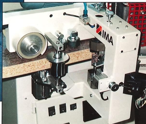
Das neu entwickelte IMA-Hand-Kantenanleimgerät ist optimal für **kleinste Losgrößen** geeignet. Durch seine **hohe Flexibilität** und **kurze Rüstzeiten** können z.B. auch **einzelne Arbeitsplatten** und **Sonderanfertigungen** schnell und mühelos bearbeitet werden.
