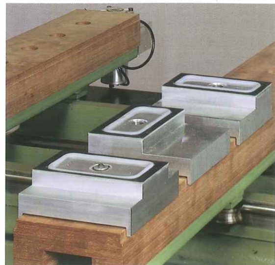
Schmalsauger für min. Werkstückgröße 70 x 140 mm.
