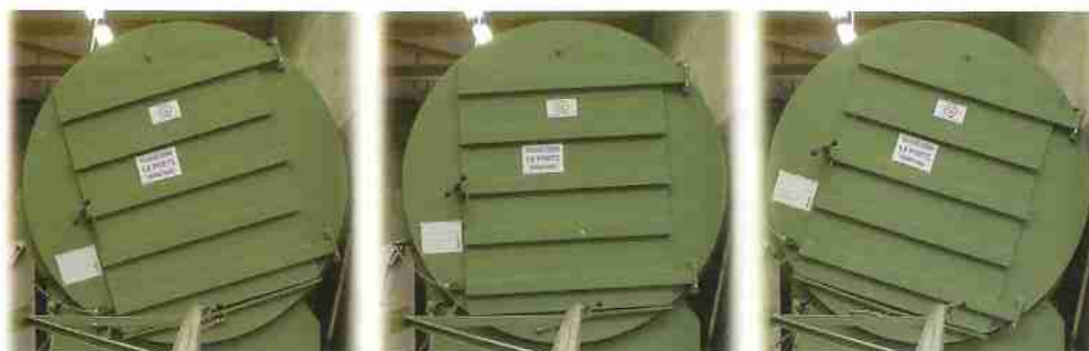
Impianto PG oscillante swinging pressure treatment system dispositif d'imprégnation oscillant impregnador oscilante
