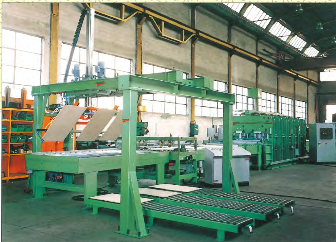
Zona di scarico dei pannelli nobilitati con ventose ribaltanti per l'ispezione e controllo qualità della faccia inferiore.
