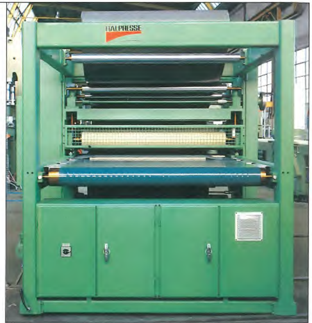
Lato scarico pannelli dall'accoppiatore carte con tappeto acceleratore. Panel unloading from the coupling machine, with accelerating belt. Côté de déchargement des panneaux de l'accoupleuse des papiers avec tapis accélérateur. Werkstück Auslaufseite der Kaschieranlage mit Beschleunigungsband. Lado de descarga tableros de la desbobinadora de papeles con tapiz acelerador.
