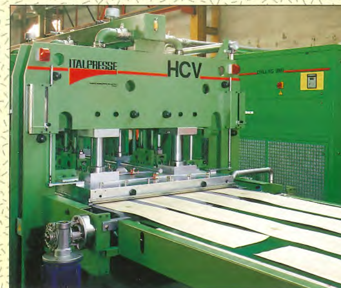
Lato scarico pressa a freddo con pacchi di tranciati stirati.
