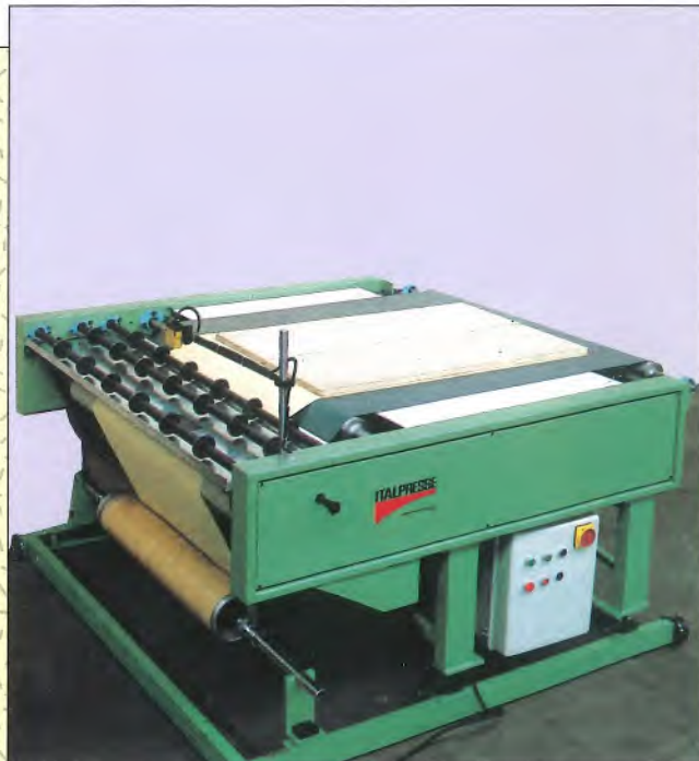
Accoppiatore automatico per carte sulla faccia inferiore del pannello. Automatic coupling machine, for lower face of the panel. Accouplement automatique pour papiers sur le côté inférieur du panneau. Automatische Kaschieranlage zur einseitigen Beschichtung von Werkstücke. Desbobinadora automática de papel sobre la cara inferior del tablero.
