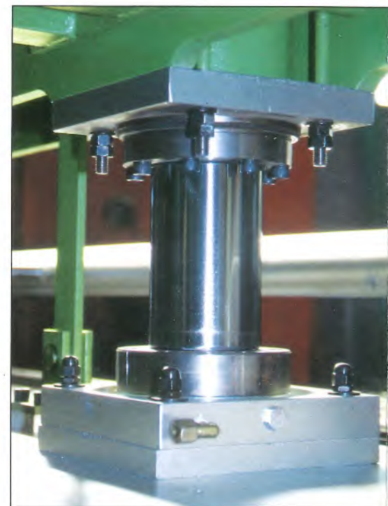
Particolare cilindri e relative piastre di raffreddamento.
