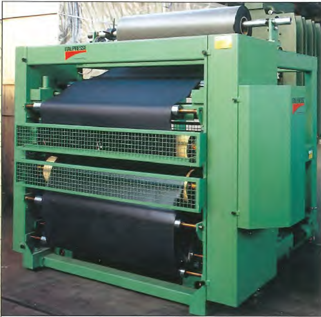
Lato introduzione pannelli nell'accoppiatore carte su due lati. Panel feeding side panels into the two face coupling machine. Côté d'introduction des panneaux de l'accoupleuse des papiers avec tapis accélérateur. Werkstücke Einlaufseite in der beidseitigen Kaschieranlage. Lado de introducción tableros en la desbobinadora de papeles sobre los dos lados.
