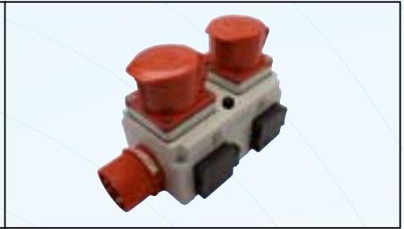
Einschaltfrietomat 1 M zum Betreiben von 1 Drehstrom- bzw. 1 Wechselstrom getriebenen Maschine sowie 1 Entstauber mit 230V oder 400V. Mit Pha- senwender (erweiterbar bis 8 Maschinen)
