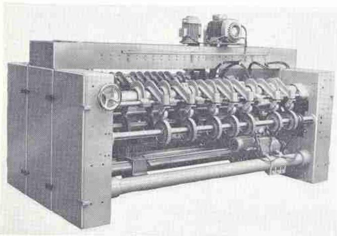
Vierseitige Formatsäge, aufgebaut aus Jonsereds Baukastensystem EB
