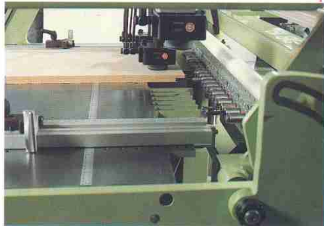
Automatischer Höhenausgleich beim Schwenken von Flächen- auf Stirnbohrungen.
