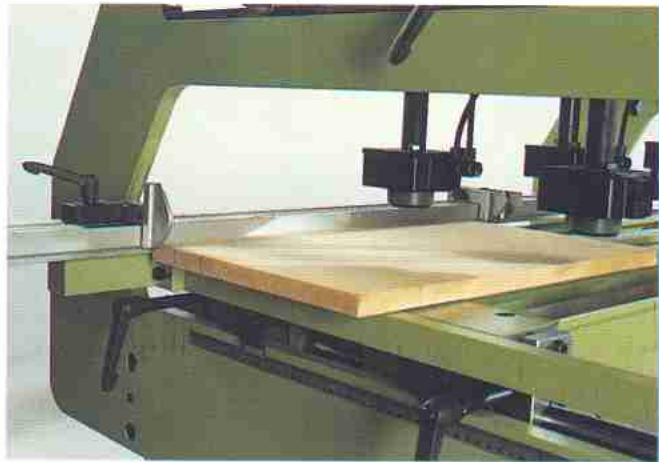
Automatischer Höhenausgleich beim Schwenken von Flächen- auf Stirnbohrungen.
