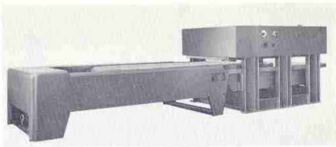
Automatische hydraulische Furnier- presse mit Beschickungs- und Ent- ladeeinrichtung Typ HDP-200
