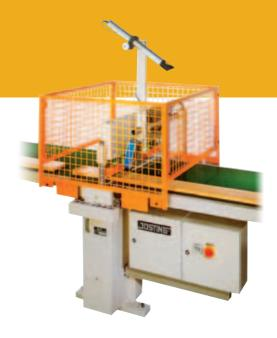
Quer-Furnierschere QFS 850 A zum automatischen Ablängen von Furnierpaketen, mit einem Zuführ- und Abführ-Förderband, regelbarer Durchlaufgeschwindigkeit und Schnittstellenmarkierung durch Spezialkreide.
