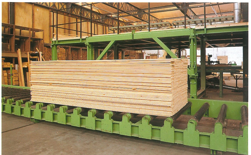
Profilbrett-Stapel auf verfahrbarem Paket-Rollenförderer zur Stapelmaschinenentsorgung
