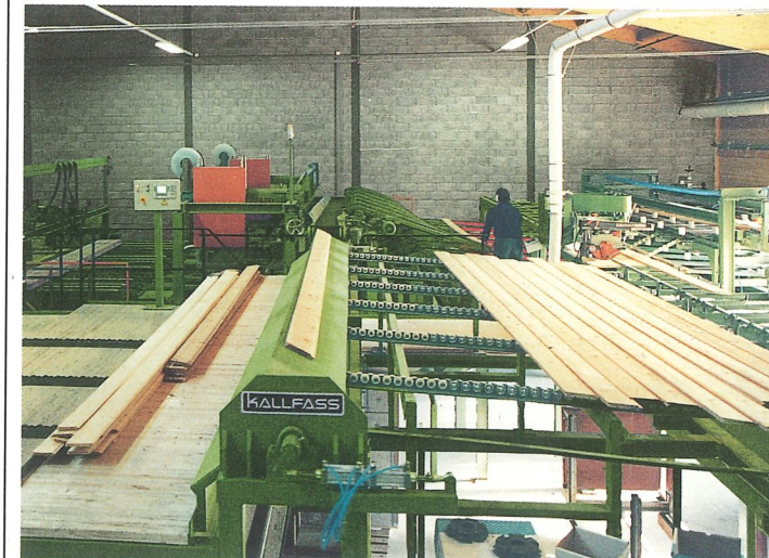
Aussortierung von Ware zur Reparatur mit anschließender Wiedereinschleusung Astflick- und Kappstation
