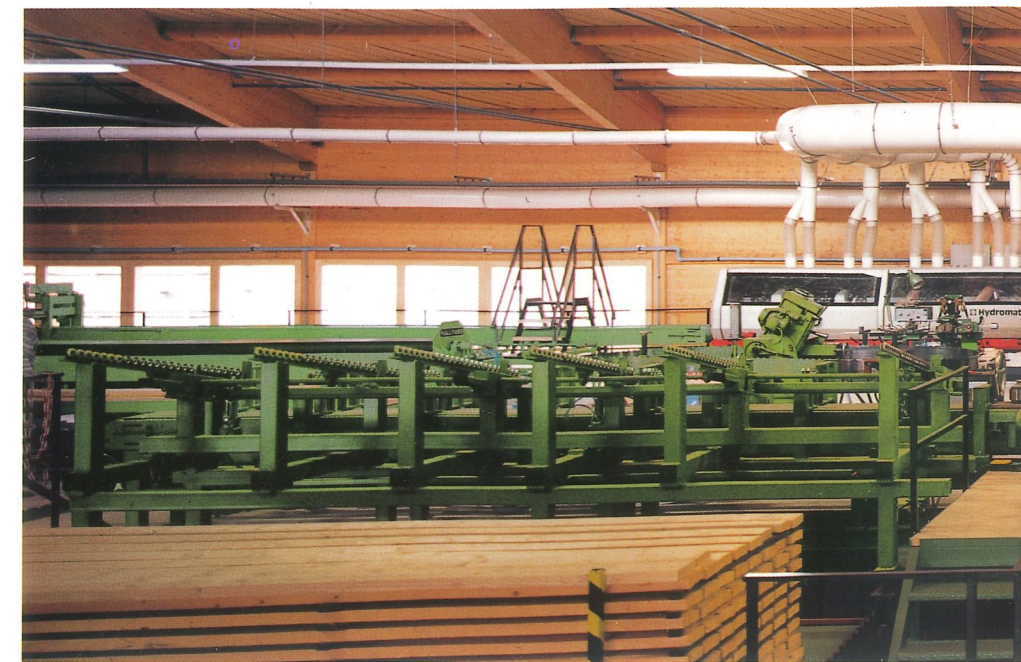
Hobelmaschinen-Mechanisierung Type HMKvH 6000, einlaufseitig, mit Bandsägen-Mechanisierung
