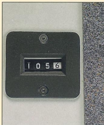
Die Anzeige für die Hobelhöhe ist gut ablesbar oben in die Abdeckhaube eingebaut. Die Einstellgenauigkeit beträgt 0,1 mm.
