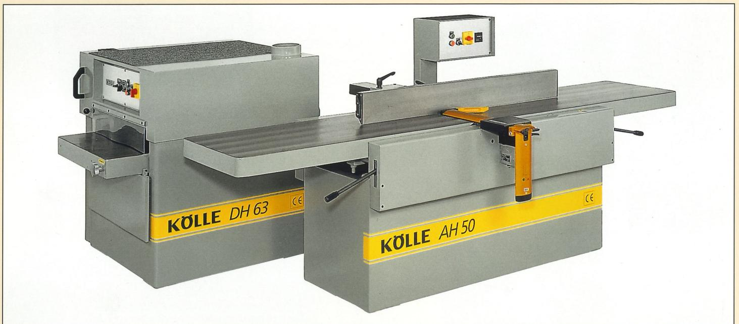
Die abgebildete Aufstellung der Abrichtobelmaschine zusammen mit der Dickenobelmaschine gibt einen guten Arbeitsablauf und erfordert wenig Platz. Die Abrichtobelmaschine wird an der Ständerrückseite abgesaugt und die Dickenobelmaschine am Stützen auf der Abdeckhaube. Die gemeinsame Absaugleitung wird zwischen beiden Maschinen installiert.
