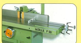
Sowohl die Tischfräsmaschine F 50 wie auch die Schwenkfräsmaschine F 45 erhalten Sie auch mit verlängertem Maschinentisch (2200 mm). Die ausziehbare Auflage wird in den Längen 1200, 2200 oder 3000 mm geliefert. Zum verlängerten Maschinentisch gibt es den Queranschlag zum Einsetzfräsen. Dieser kann an der rechten und linken Tischseite verwendet werden.
