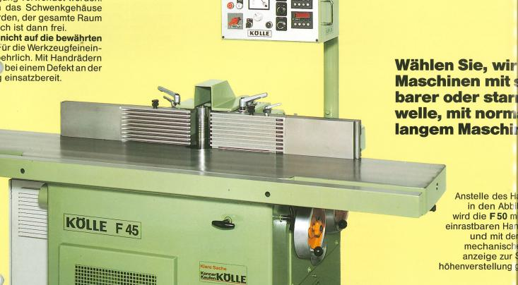
KÖLLE F 45 Schwenkfräsmaschine
