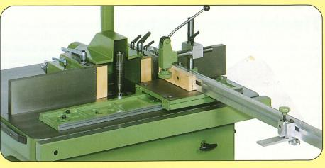
Für schwere Zapfenschneid- und Schlitzarbeiten empfehlen wir unseren Rolltisch mit zurückschiebbarer Rolltischlaufschiene. Der Rolltisch kann an der F 45 wahlweise an der vorderen oder an der linken Maschinenseite angebaut werden. Beim Anbau an der vorderen Maschinenseite kann die F 45 auch mit langem Maschinentisch geliefert werden, und es können mit schräggestellter Frässpindel auch schräge Zapfen und Schlitze gefräst werden. Das Modell F 50 ist nur mit links angebautem Rolltisch lieferbar.
