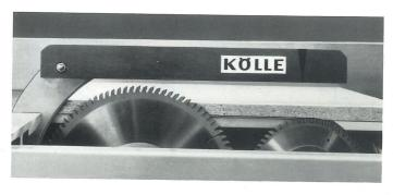
Die Vorritzkreissäge wird gegen Mehrpreis eingebaut. Das zweiteilige Ritzkreissägeblatt ist genau auf die Schnittbreite des Hauptkreissägeblatts eingestellt. Die Vorritzkreissäge schneidet unten im Gleichlauf ca. 2 mm tief vor und verhindert dadurch Ausrisse an der Unterseite von beidseitig beschichteten, belegten oder überfurnierten Platten.
