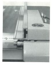
Das Anschlaglineal des Sägelängsanschlags ist in der Schnittrichtung verschiebbar. Zum Schneiden von schmalen Teilen wird ein zweites Anschlaglineal mit niederer Führungskante verwendet. An diesem Lineal können auch Teile mit überstehendem Belag gesägt werden. Der Sägelängsanschlag kann in der hinteren Endstellung abgeschwenkt werden.
