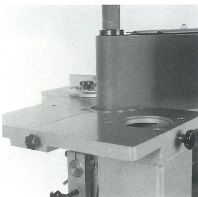
Schleifen von geschweiften Teilen an der gummierten Bandspannwalze mit Durchmesser 75 mm
