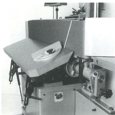
Der Tisch auf der Massivschleifseite ist bis 45 Grad neigbar
