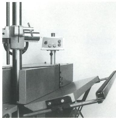
Ansicht auf den bis 30 Grad schrägstellbaren Furnierschleiftisch, die Tischverbreiterung (Zubehör) und das wahlweise aufbaubare Vorschubstativ
