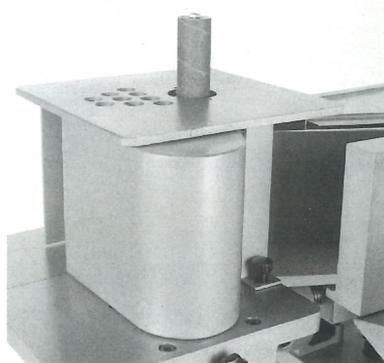
Wahlweise Verwendung eines Zusatztisches mit Schleifwalzen für den Innen- und Aussenschliff ab Durchmesser 25 mm
