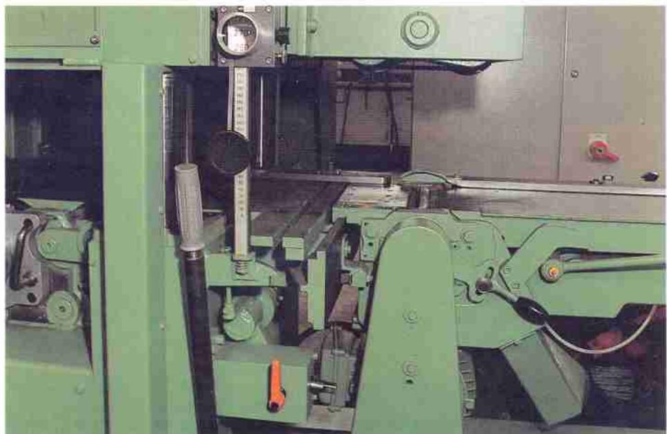
Untere Messerwelle mit Gegenlager und darüberliegenden Druckelementen – Angetriebene Vorschubwalzen –
