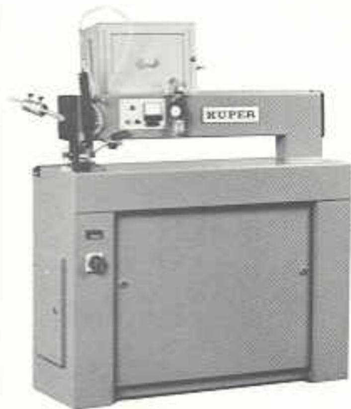
Die FW/J - inzwischen vieltausendfach bewährt - schließt eine Bedarfslücke speziell für Handwerksbetriebe, wo man bisher aus Platz- und Kostengründen auf die große FW verzichtet hat. Ein besonders preisgünstiges und leistungsfähiges Modell. Zur Verarbeitung von Fugenpapier kann die Maschine umgerüstet werden.
