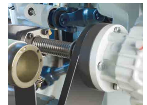
Positionierachsen mit Kugelrollspindel und Drehgeber
