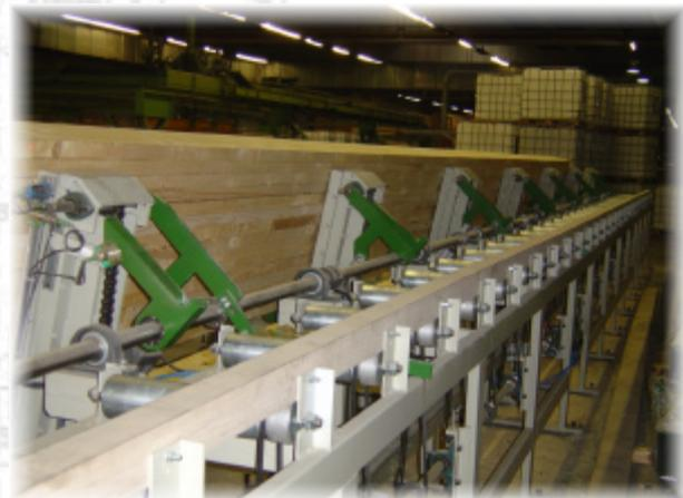
*Halbautomatische Lamellenvereinzelung und Übergaberollenbahn zur Hobelmaschine*
