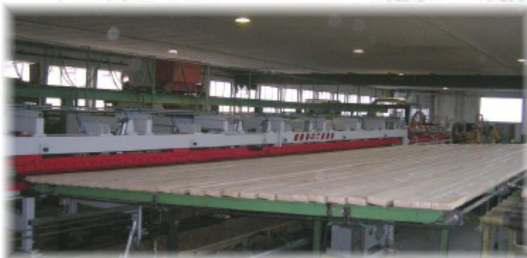
Stirnseitenpresse mit anschließendem Quertransport als Aushärtelager und Übergabe zur nachfolgenden Hobelmaschine
