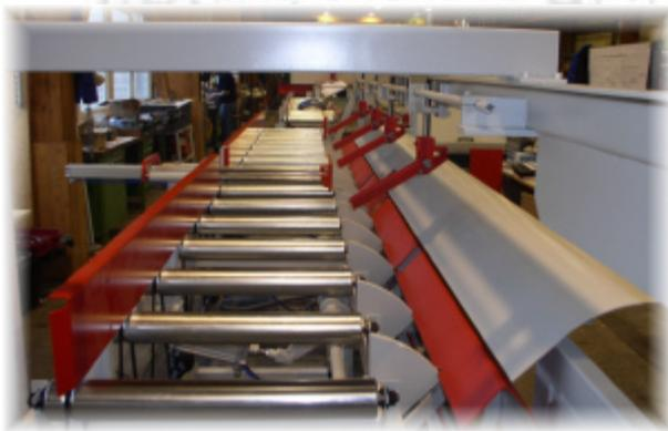
Vollautomatische Paketierstation mit pneumatischen Wendeklappen
