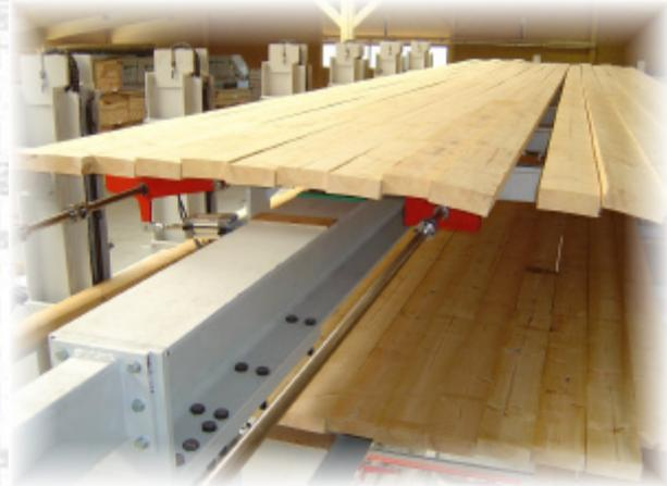
*Doppelstöckiges Querlager, beschickt und entleert wird über Paternosterarme*
