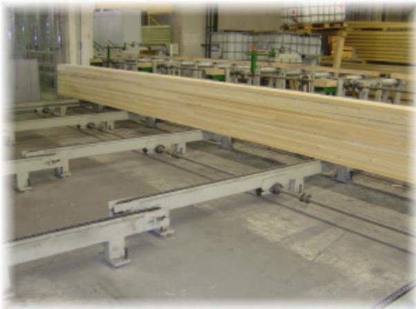
*Aushärtelager, hier als getrennt angetriebener Quertransport*
