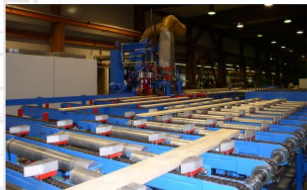
*Quertransport zur Beschickung der Fräse*
