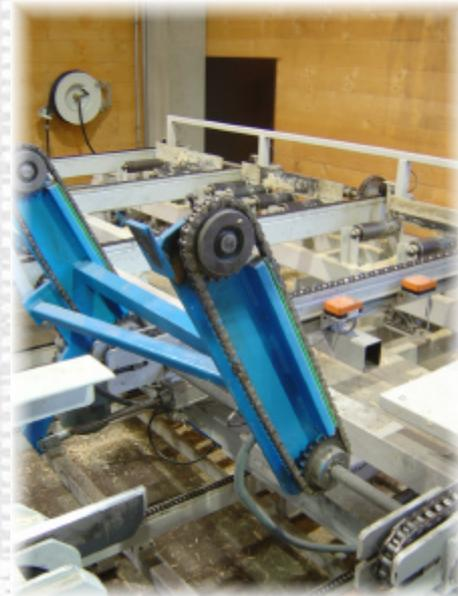
Schwenkbare Verteilerklappe zur Übergabe der Hölzer auf 2 Ebenen
