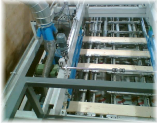
Fräsaggregat mit Zerspaner, Fräsern und Leimangabe
