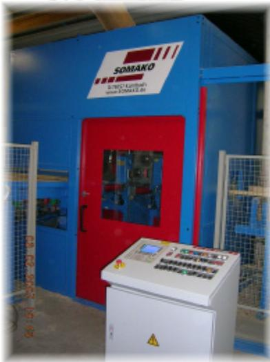
*Schallschutzkabine mit Steuerpult*
