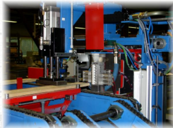
*Leimauftrag, getrennt vom Fräsaggregat, berührungslos*
