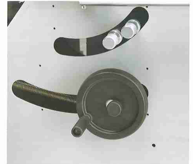
Regolazione manuale esterna incisore Réglage manuel externe inciseur External scorer manual adjustment Externe Handregelung für Vorritzer Regulación manual externa incișor
