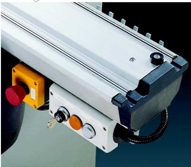
Comando abilitazione gruppo post-forming Commande habilitation groupe post-forming Post-forming unit enable button Ansteuerung zur Freischaltung der Postforming-Gruppe Mando habilitación grupo post-forming
