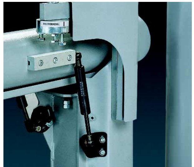
Micro su protezione a ponte versione post-forming Micro sur protection à pont version post-forming Micro switch on overhead guard post-forming version Ansteuerung zur Freischaltung der Postforming-Gruppe Mikroschalter auf dem Brückenschutz Version Postforming Microinterruptor en la protección de puente versión post-forming
