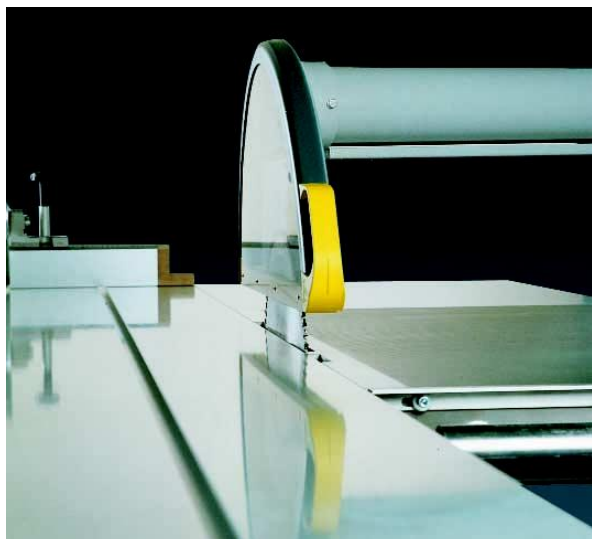
Protezione lama per taglio a 90° Protection lame pour coupes à 90° Blade guard for 90° cuts Sägeblattschutz für 90° Schnitt Protección cuchilla para corte a 90°
