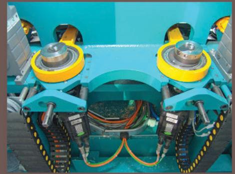
Die beiden Fräsaggregate arbeiten mit innovativen dynamischen Werkzeugbewegungen. Radiale und axiale Bewegungen der beiden Profilwellen erfolgen mittels eines Exzenterantriebs. Hub der Exzenter kann manuell verstellt werden.
