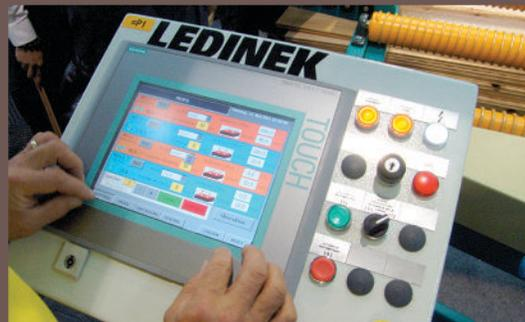
Alle Antriebe sind elektronisch zusammengeschaltet, damit die Taktung genau auf den Vorschub synchronisiert werden kann. Die Frequenz der radialen und axialen Bewegungen können stufenlos verstellt werden um unterschiedliche Muster zu erzeugen.
