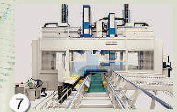
7 CNC Abbundanlage für Balken CNC machining for beams
