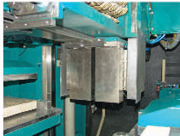
Berührungsloser Leimauftrag mit automatischer Breitereinstellung.
