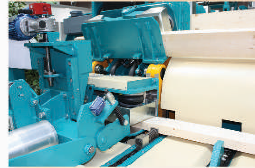
Klemmeinheiten der Hauptvorschubkette. Clamping units of the main feed chain.
