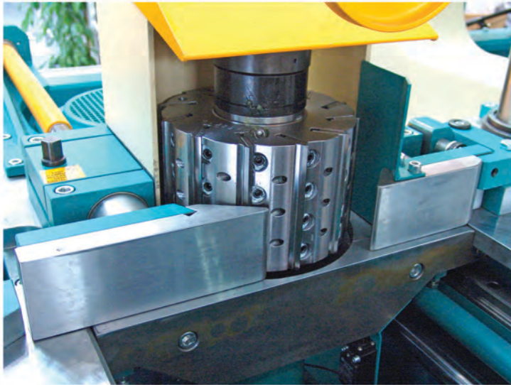
Vertikale Spindeln können auch für Profilarbeiten angepasst werden.
