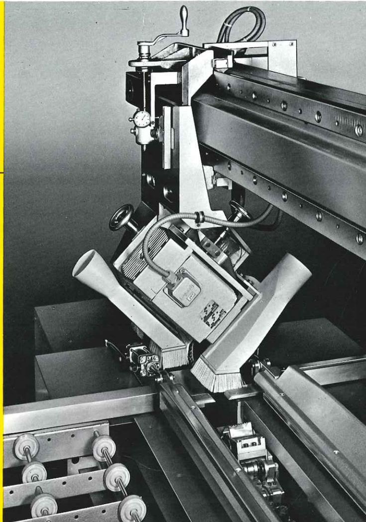
WL 35 mit Sägesupport Folienaufklebevorrichtung und integrierter Vorritzeinrichtung
