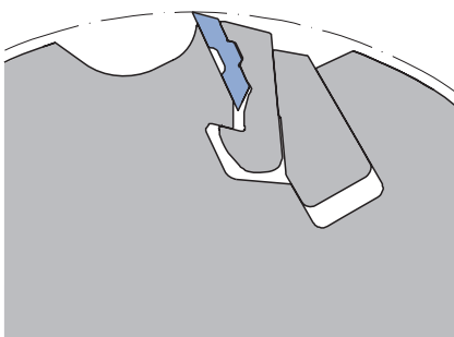
Messerkopf aus Stahl mit integriertem Spanbrecher
