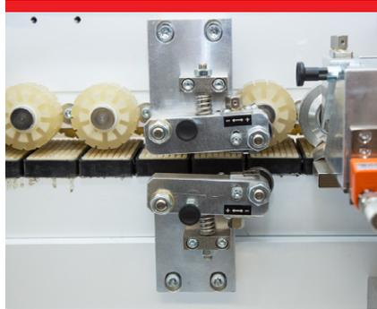
Flächenschleifaggregate: Befreit mit leicht ziehendem Schnitt die Werkstückfläche von etwaigen Kleberesten an der Leimfuge.
