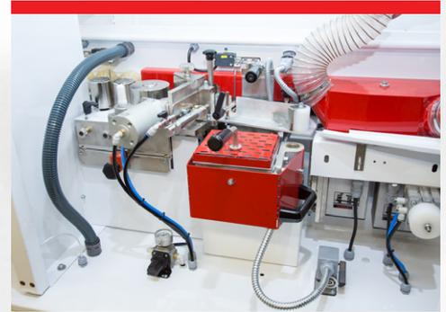
Direktleimabgabe an das Werkstück: Teflonbeschichtetes Leimbecken mit 2 kg Fassungsvermögen, auslaufsicher mit Leimvorrat von unten (Überschüssiger Leim wird automatisch dem Leimbecken wieder zugeführt), fein dosierbarer Leimauftrag mittels Leimrolle, elektronische Temperaturkontrolle mit automatischer Stand-by-Funktion (Verhindert das der Leim verbrennt, wenn die Maschine längere Zeit nicht benutzt wird aber dennoch eingeschaltet ist).
