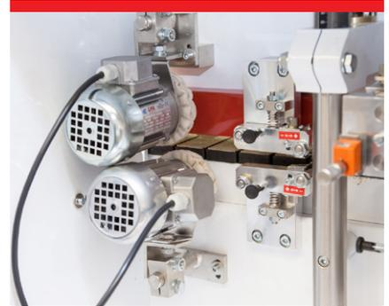
Schwabbelaggregate: 2 Motore 0,05 kW, 1.500 U/min. sorgen für ein Super-Finish für ABS- und PVC-Kantenmaterial.
