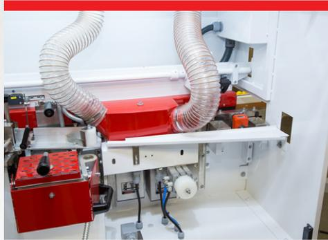
Fügeaggregat – zwei gegenläufig, einsetzgesteuert arbeitende Fügeaggregate mit diamantbestückten Spiralfügefräsern sorgen für ein sauberes und ausrißfreies Fügen der Werkstücke vor dem Anleimen der Kante.
