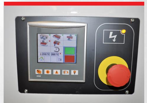
PLC-Touch Panel steuert die Leimtemperatur-Einstellungen, die automatische Temperaturreduktion bei Nichtbenutzung der Maschine, An + Ausschalten von Aggregaten und Fehlerdiagnostik.
