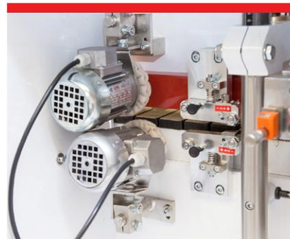
Schwabbelaggregat: 2 Motore 0,05 kW, 1.500 U/min. sorgen für ein Super-Finish für ABS- und PVC-Kantenmaterial.
