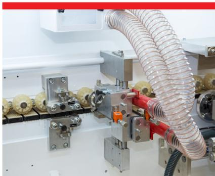
Radiusziehklagenaggregat: Durch leicht ziehenden Schnitt werden etwaige Radien-Fräser Spuren entfernt und sorgen so für ein perfektes Finish. Die Feinjustierung erfolgt über zwei Digitalzähler.
