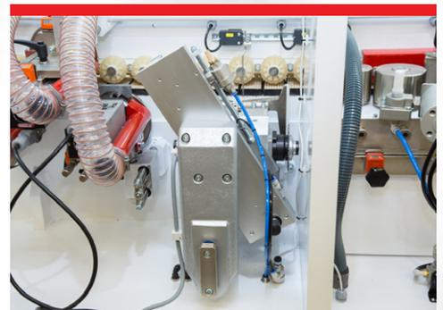
Hochfrequenz-Kappsäge ausgestattet mit HF-Motor 0,27 kW, 12.000 U/min., 2 Sägeblätter und hochpräzisen Linearführungen sorgen für einen sauberen und präzisen Sägeschnitt.
