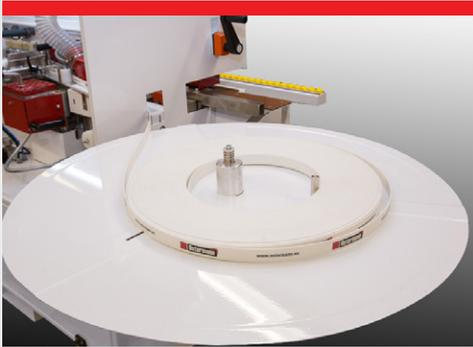
Automatische Kantenzuführung für Rollenmaterial über drehbaren Rollenteller D=800mm.
