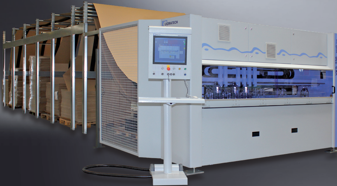
Maschinenkonfiguration mit 6 Kartonagenzuführmagazinen
