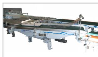
Drehstation für zweiseitigen Packbereich
