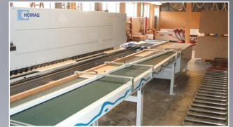
Option: Teileleiteneinrichtung für Stapelmagazin
