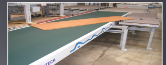
Rückförderung von langen Teilen mit automat. Drehung
