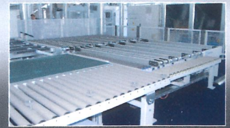
Rückförderung von langen Teilen mit automat. Drehung
