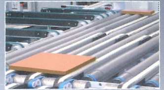
Geteilte Querriemen in der Rollenbahn
