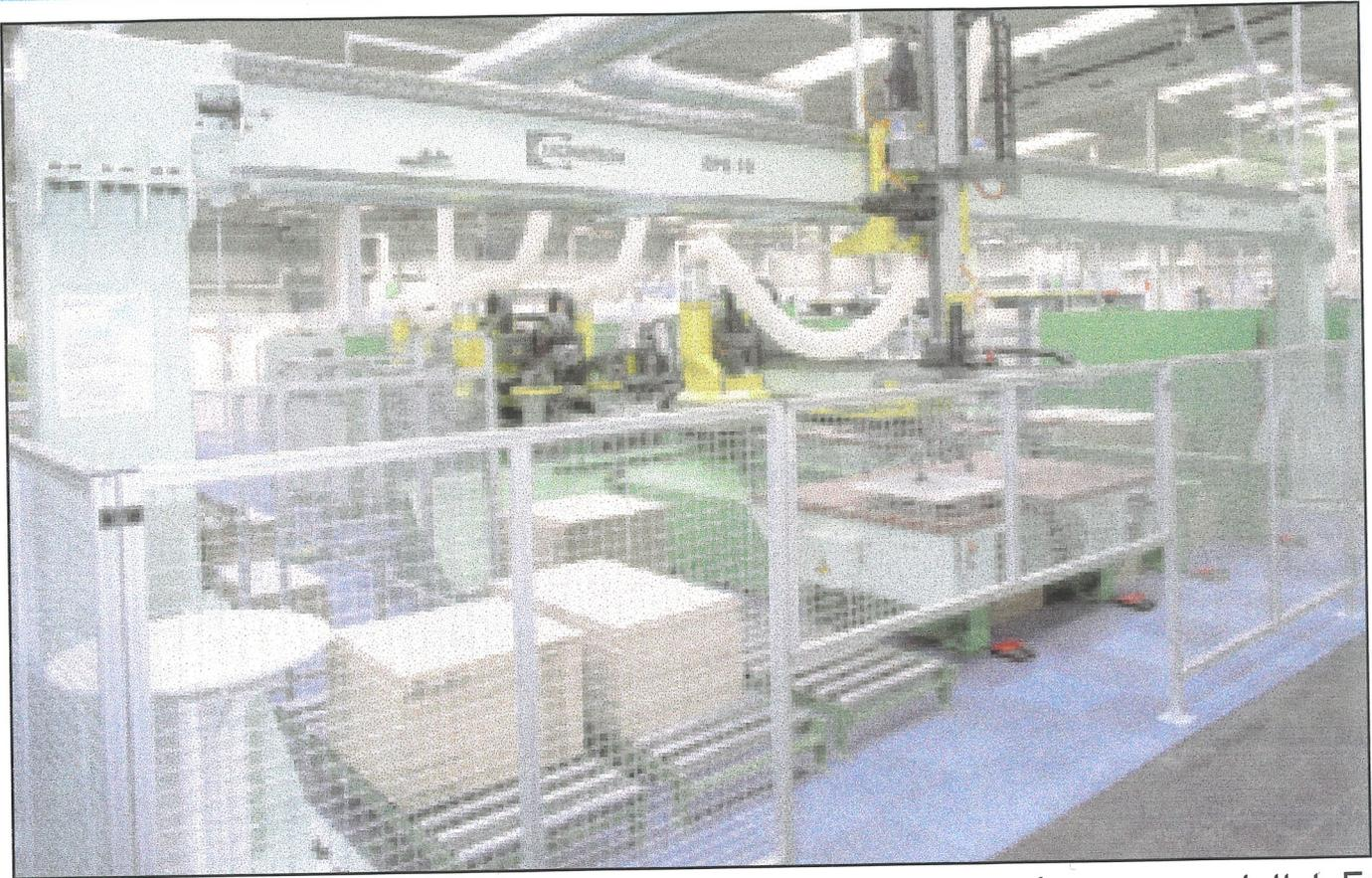
Der Stationärbeschicker ZPS 05/10/50 ist mit drei linearen Hauptachsen ausgestattet. Er dient zur Handhabung von plattenförmigen Werkstücken an Bearbeitungszentren.
