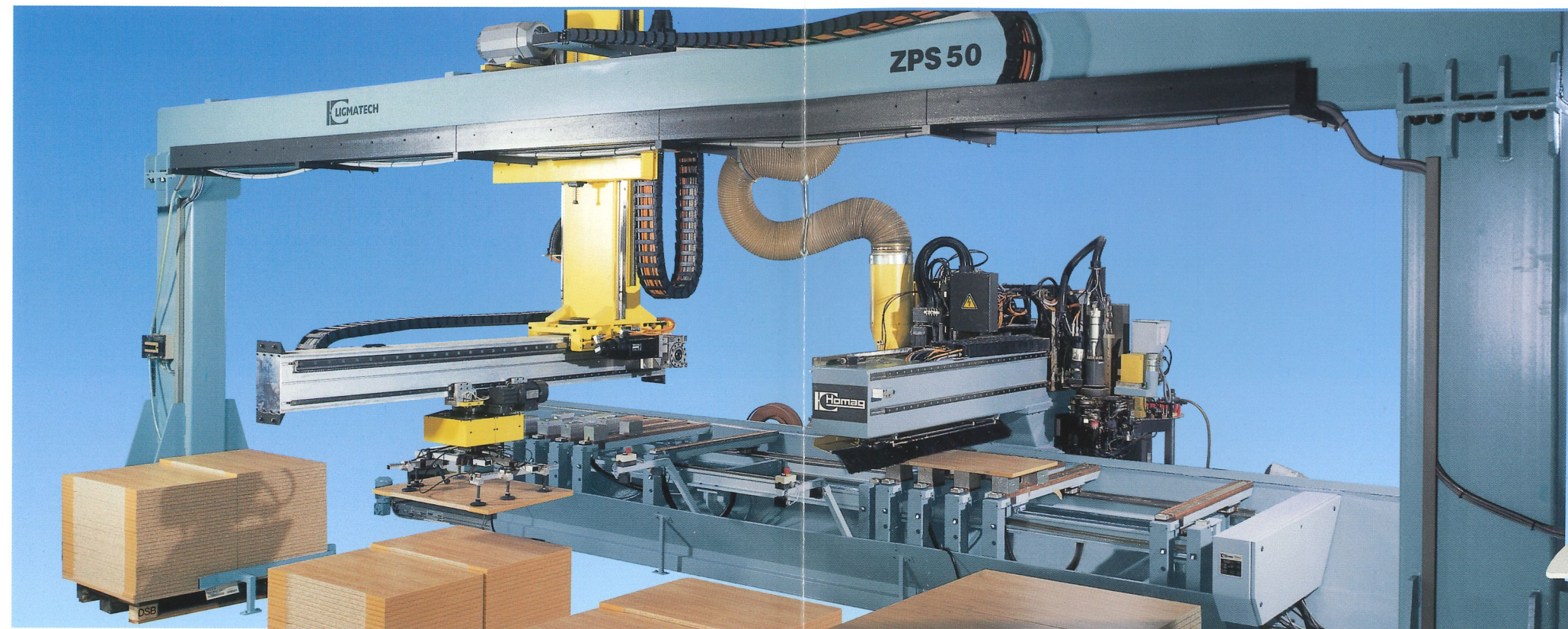
Stationärbeschicker ZPS 50 an einem Homag BAZ mit Kantenbearbeitung
