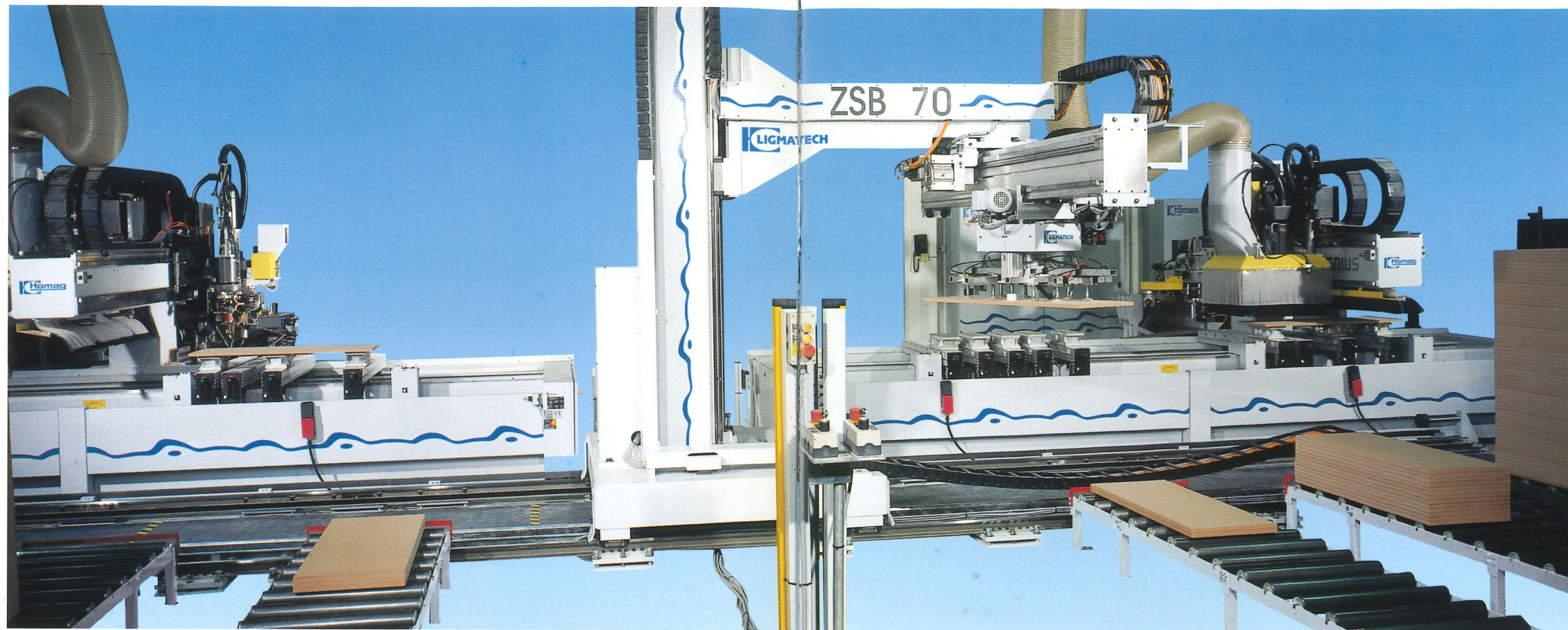
Stationärbeschicker ZSB 70 an zwei Homag BAZ mit Kantenbearbeitung
