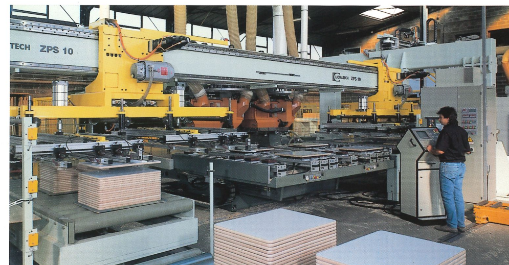
ZPS 10 an einer Oberfräse mit 1-, 2- oder 4-fach Belegung gleichzeitig ohne Anschläge
