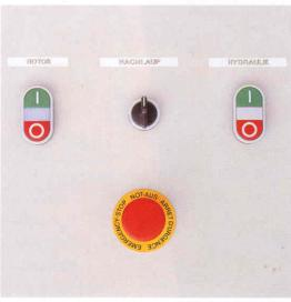
Da in vielen Betrieben durch den Einsatz des Wellenhackers während der Normalarbeitszeit die Obergrenze der Stromleistung überschritten wird, und dies mit erheblichen Mehrkosten verbunden ist, wird die Maschine standardmäßig mit einer Nachlaufzeitsteuerung ausgestattet. Dadurch kann die Maschine ohne Personalaufwand nach Arbeitsschluß betrieben werden und schaltet bei leerem Einfülltrichter selbständig aus.
