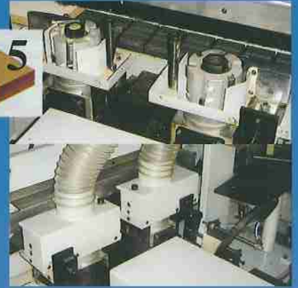
Grupo rectificador a tiempo HF con 2 motores a 12.000 rpm.
