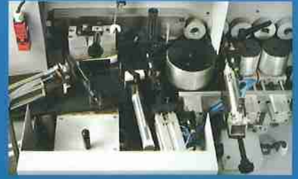
Grupo cizallas: 1º cizalla con sistema neumático, para corte de rollo en PVC y ABS - espesor máx. 3 mm. - 2º cizalla con sistema neumático, para corte de rollo de 0,4-1 mm.
