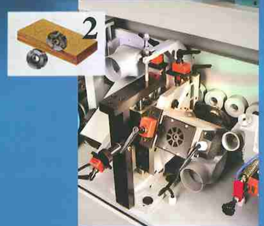
Grupo reparador con 2 motores inclinables HF de 0º a 45º a 12.000 rpm.
