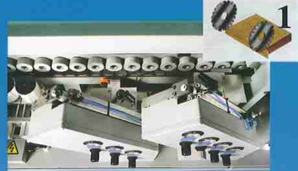
Grupo retestador doble disco con 2 motores inclinables HF de 12.000 rpm.
