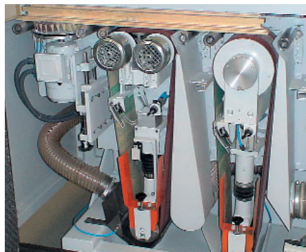
Je Seite 2 Schleifbänder + Disc. Top-Finish für Fensterteile
