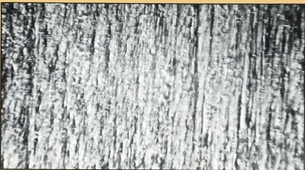
12fache Vergrößerung der geschliffenen Fläche nach dem Tauchen, Holzfasern in den Poren aufgerichtet – rauhe Oberfläche.
