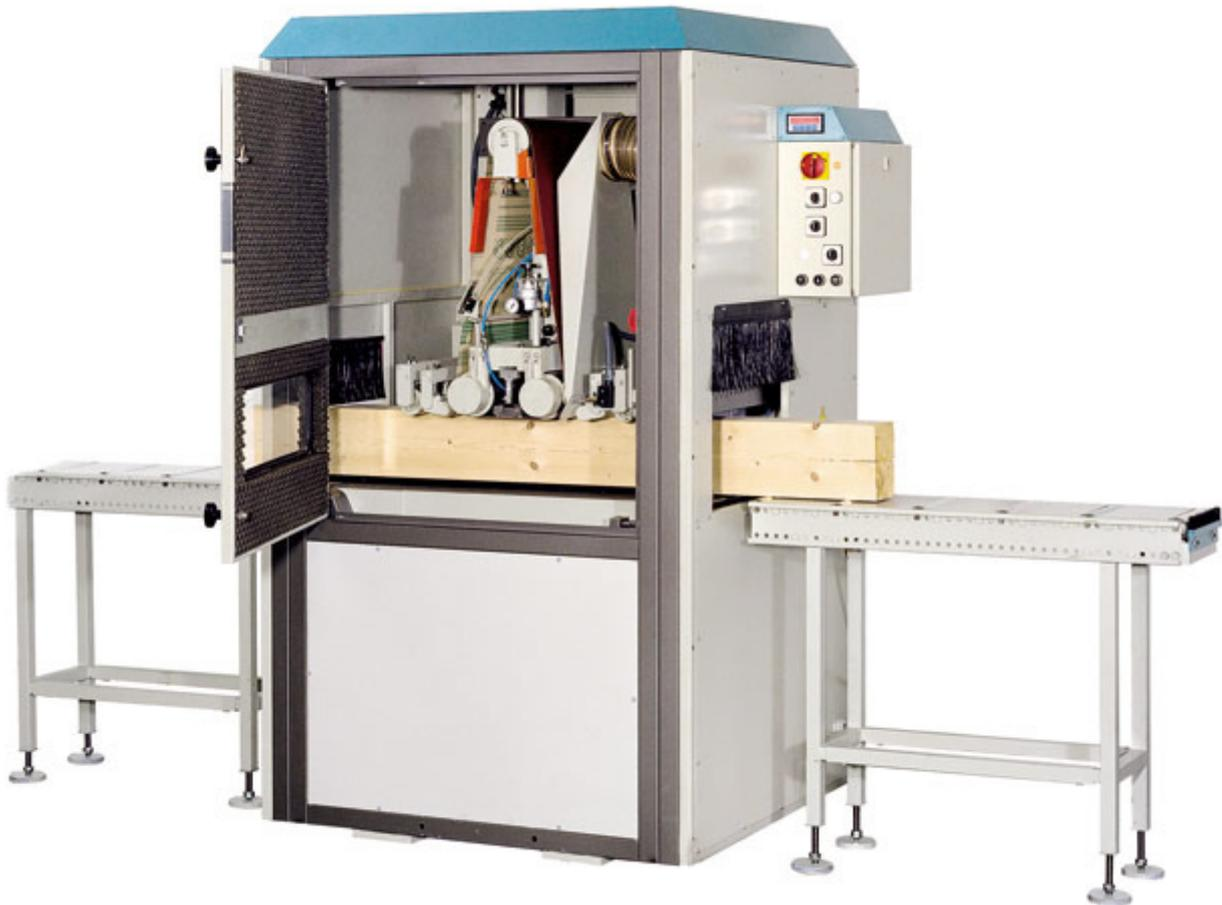
Die von oben schleifende HBS 400 ist eine ausgesprochen vielseitig einsetzbare Massivholzschleifmaschine. Ausgerüstet mit einem Kombiaggregat ist entweder mit der gummierten Walze eine Kalibrierung auf Maß oder aber ein mit dem Luftschleifschuh dem Werkstück angepasstes Schleifen möglich. Mit einer Schleifbandbreite von 400 mm und einem Durchlass von 400 mm schleift dieses Modell auch größere Querschnitte.
