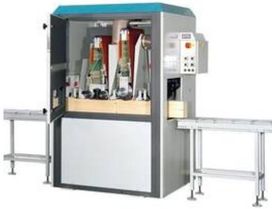
vorgesetztes schweres Walzenaggregat für den Vorschliff, das folgende Kombiaggregat schleift feiner nach. Mit dem optionalen verschleißfesten CERMET Schleifschuh ist dies die bevorzugte Maschine für den hochwertigen Wintergartenbau.
