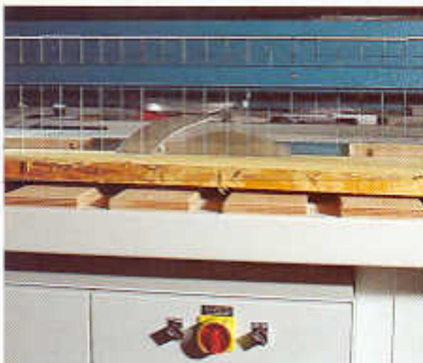
Stufenlos höhenverstellbares Kreissägeblatt.
