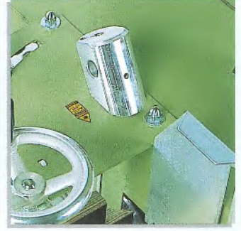
Die neue Lasertechnik ermöglicht Ihnen den Anriss mm-genau auszurichten.
