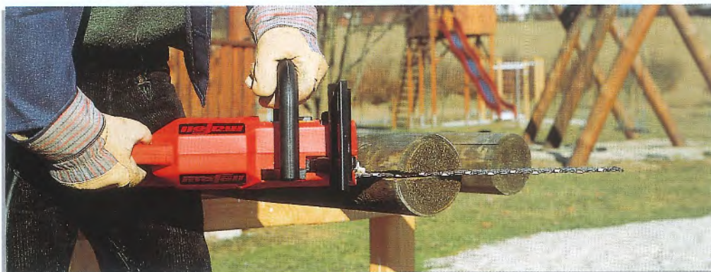
Die EKS 400 S kommt in erster Linie dort zum Einsatz, wo eine ausreichende Auflagefläche am Holz nicht vorhanden ist, wie z.B. bei der Bearbeitung von Rundholz.
