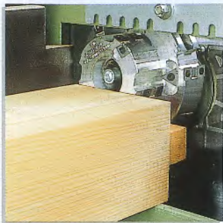
Ob gerade oder schräge Zapfen, die Steuerung ermöglicht eine 4-seitige Bearbeitung in einem Arbeitsgang. Damit sind alle Zapfen auch ringsum angefast.
