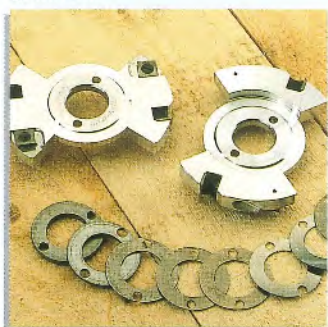
Die Breitereinstellung des Verstellnuters erfolgt durch Kombination unterschiedlicher Distanzringe.
