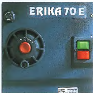
Der Ein- und Ausschalter liegt rechts. Sie bedienen die Maschine ausschließlich mit der rechten Hand. Die linke bleibt am Werkstück.
