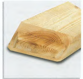
Für schräge Zapfen wird das Fräsaggregat einfach geschwenkt.
