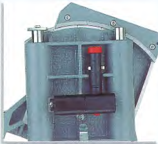
Für Einstiche schräg zur Holzseite: Schrägverstellbarkeit von 45° in beide Richtungen.
