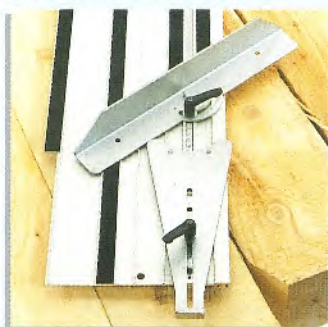
... und links am Sparren Ihre Nuten mit der Führungseinrichtung (Sonderzubehör) fräsen. Die Winkelumstellung ist schnell gemacht.
