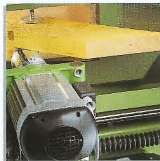
Der Spezialfräskopf ermöglicht auch Ausplattungen für First- und Eckblätter. Die Werkzeugumstellung hierzu ist schnell und einfach.
