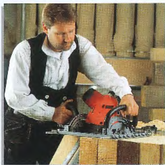
Große Schnitttiefe auch bei Schrägschnitten.
