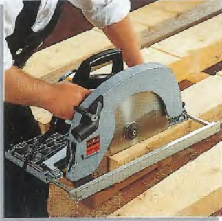
Längsschnitte bei voller Schnitttiefe erfordern leistungsstarke Maschinen wie die MKS 105 E.
