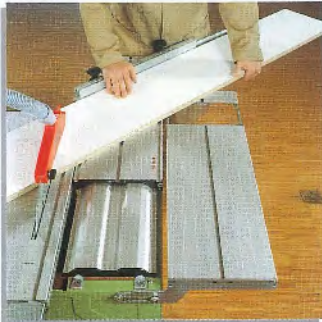
895 mm Weglänge des Teleschlittens zusammen mit dem Zusatztisch lassen auch lange Schnitte an großdimensionierten Werkstücken zu.
