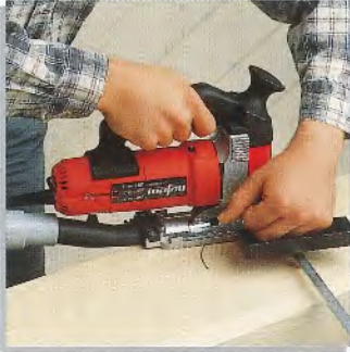
Sinnvolles Sonderzubehör macht die STA 65 E noch variabler: Hier: der Kreisschneider für Durchmesser von 100 – 700 mm.
