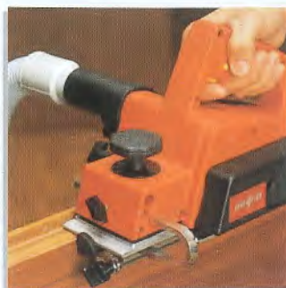
Nachfalzen einer Tür mit dem MHU 82.
