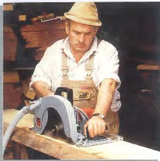
Die MKS 125 E ist mit einer intelligenten Steuerungselektronik ausgestattet. Diese sorgt für Sanftanlauf und konstante Drehzahl bei Last, ebenso für eine maschinenschonende Drehzahl-Absenkung im Leerlauf und für Überlastschutz.
