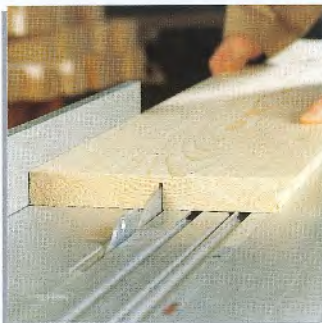
Einfach durchdacht: der absenk- bare Spaltkeil beim Nuten und Falzen.
