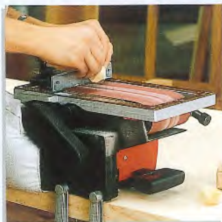
Zwei Schraubzwingen und ein Auflage-Schleifrahmen mit verstellbarem Anschlag machen den ZUB 110 im Nu zur kleinen stationären Schleifmaschine.
