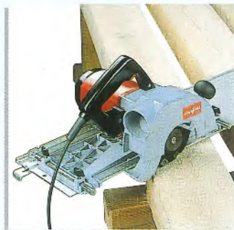
Führungseinrichtung mit Winkelanschlag und Adapter als Sonderzubehör.
