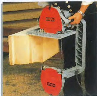
Profilierung von Pfetten und Sparren.
