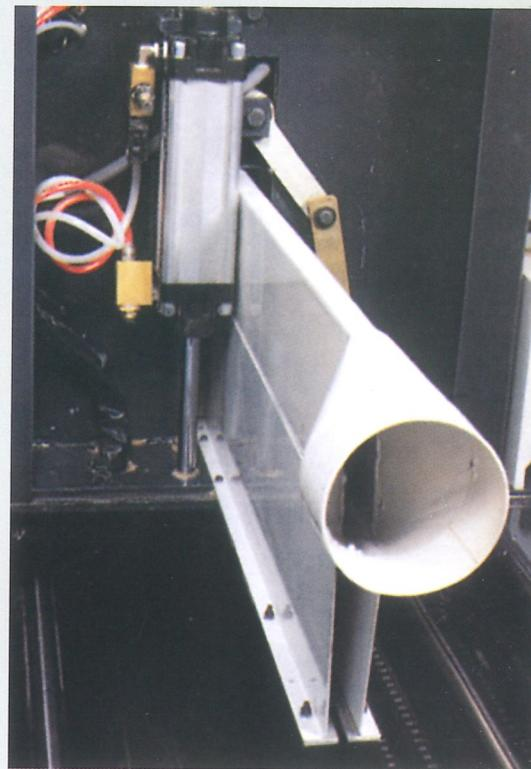
Solido corpo pinza con montaggio del cilindro in posizione verticale, ottimale per garantire un'elevata forza del bloccaggio del pannello.
