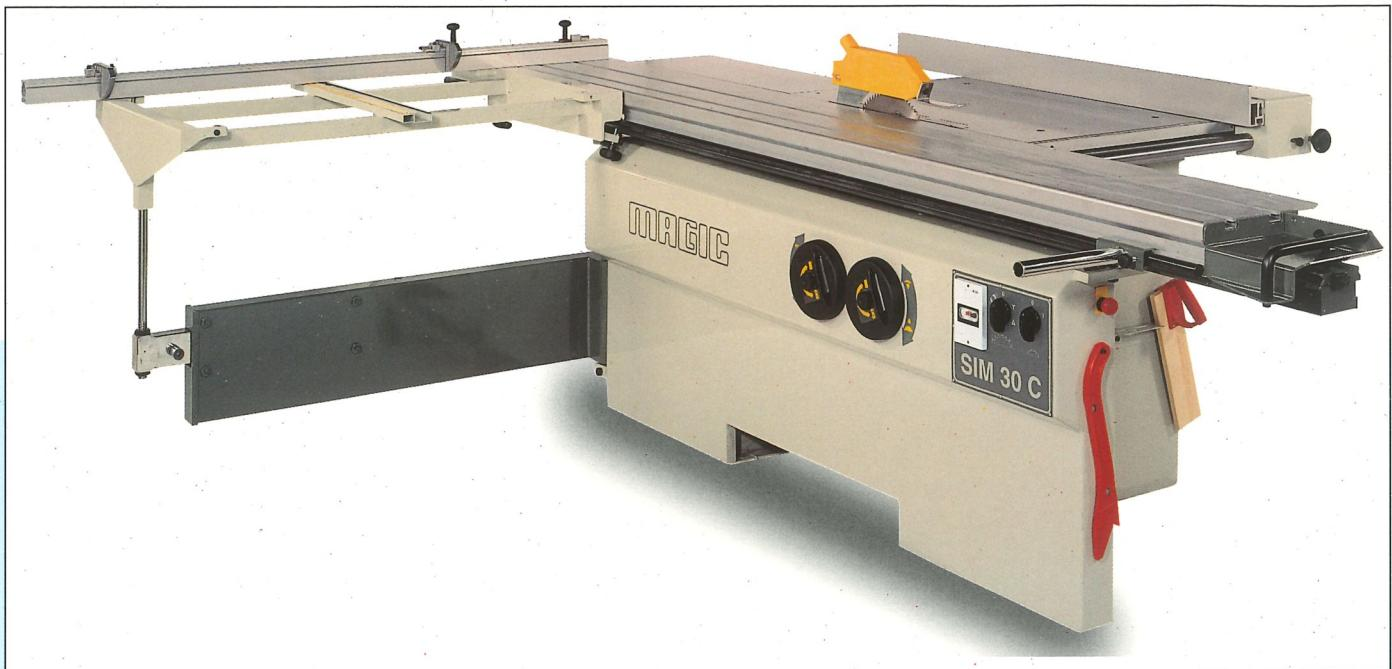
La macchina ha una struttura tale da consentire la scomparsa completa del braccio telescopico di supporto del carrello ausiliario, quando questo non è montato, lasciando completamente libera la zona di lavoro. I comandi sia elettrici che meccanici sono tutti facilmente accessibili. L'inclinazione del gruppo sega è comandata da un volantino posto sul fronte della macchina mediante una robusta trasmissione con cardano e vite senza fine.
