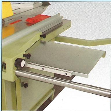
Protettore a parallelogramma registrabile longitudinalmente sul supporto quindi adattabile a macchine diverse. La registrazione in altezza è affidata ad una molla a gas.
