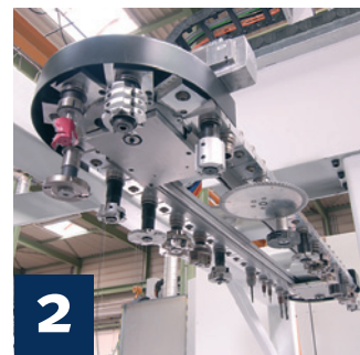
2 Werkzeugmagazin Werkzeugkettenmagazin mit 51 Magazinplätzen
