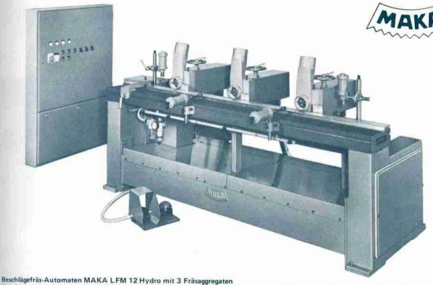
Maschinenprogramm mit Hydrauliksteuerung der Höhen- und Längsbewegungen der Fräsaggregate. Momentumstellung auf unterschiedliche Fräsbilder durch Austausch von Programmplatten.
