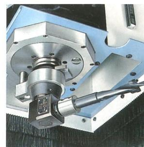
Damit werden Bohrungen in der Fläche und an den achsparallelen Kanten in die Bearbeitung einbezogen. Einschränkungen beim Würfelmaß müssen dafür in Kauf genommen werden.
